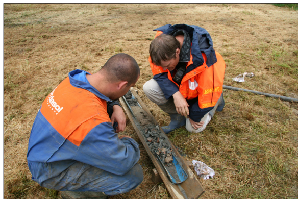
Fig. 17. Rezé, Saint-Lupien, zone 4. Prélèvements des forages placés dans des caisses pour traitement et analyse (cl. O. de Peretti, 2008).
