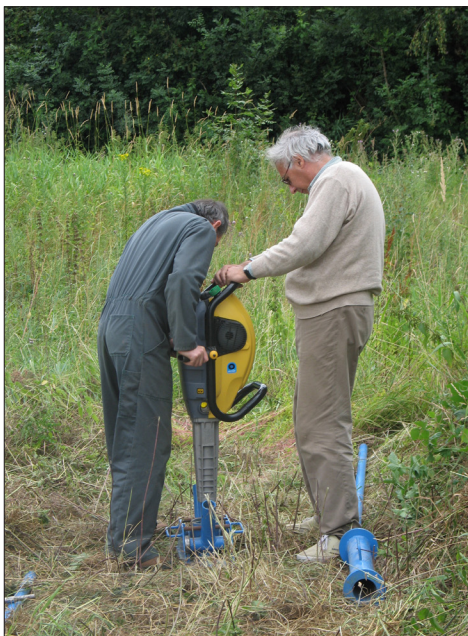
Fig. 15. Rezé, Saint-Lupien, zone 4. Utilisation d'un carottier à percussion et à moteur thermique du laboratoire Géolittomer (UMR 6554, Nantes) (cl. O. de Peretti, 2005).
